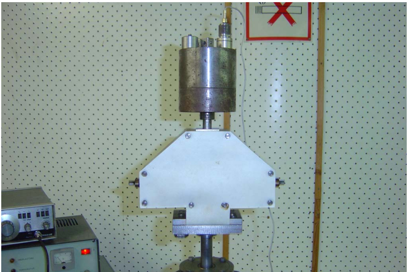
Masa chroniona z czujnikiem przyspieszeń drgań i widok wibroizolatora WoSSO
