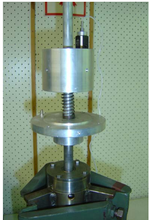
Stanowisko do badań wibroizolatorów passywnych i eliminatorów drgań
