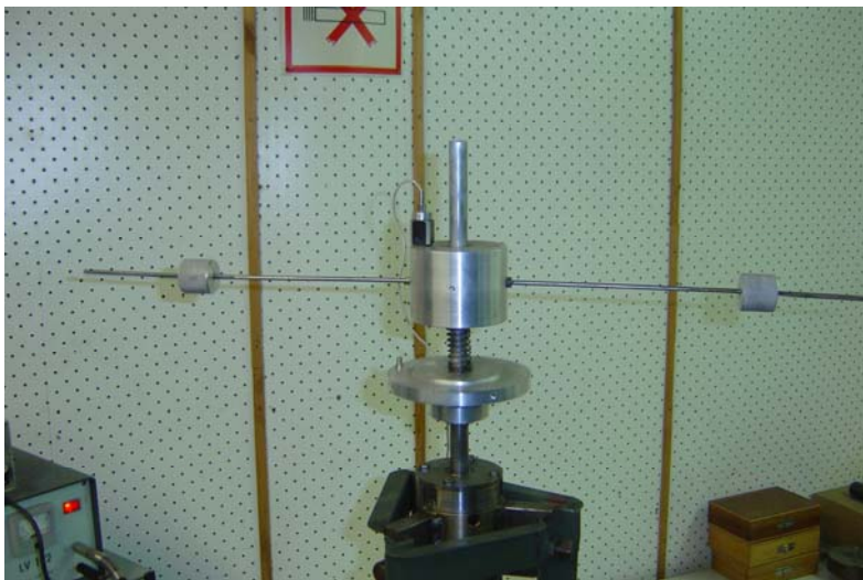
Stanowisko do badań wibroizolatorów passywnych i eliminatorów drgań
