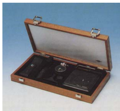
Całkujący miernik drgań B&K 2513 oraz zestaw do pomiarów drgań miejscowych
