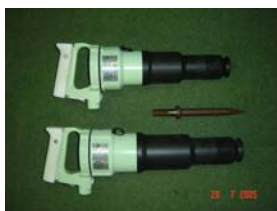
Opracowane w Laboratorium D&E M:C-TO-Ś i wdrożone do produkcji drganiowo-bezpieczne i ergonomiczne młotki pneumatyczne do mechanizacji różnych prac
