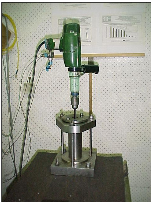
Rys. 1. Widok wiertarki uderzeniowo-obrotowej użytej w systemie biomechanicznym Człowiek – Uderzeniowe Obrotowe Zmechanizowane Narzędzie Ręczne wymagające użycia obu rąk w procesie pracy
