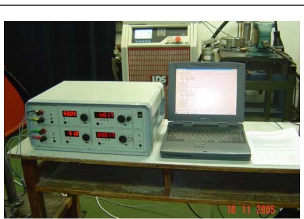
Kontrolny system pomiarowy poprawności pracy badanego sterownika transformatora
