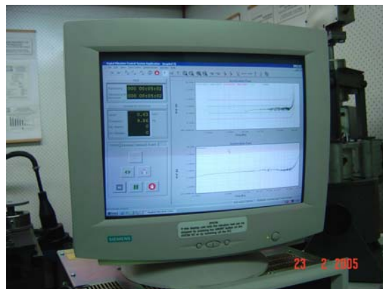
Ekran sterownika z bieżącą wizualizacją przebiegu zaprogramowanego testu drgań ogólnych
